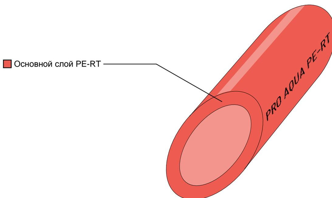
1.3 Труба напорная Pro Aqua из полиэтилена повышенной термостойкости (PE-RT) S 3.5 / S 4.5 производится в красном цвете.
